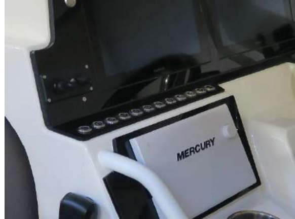
Interruttori del posto di guida
