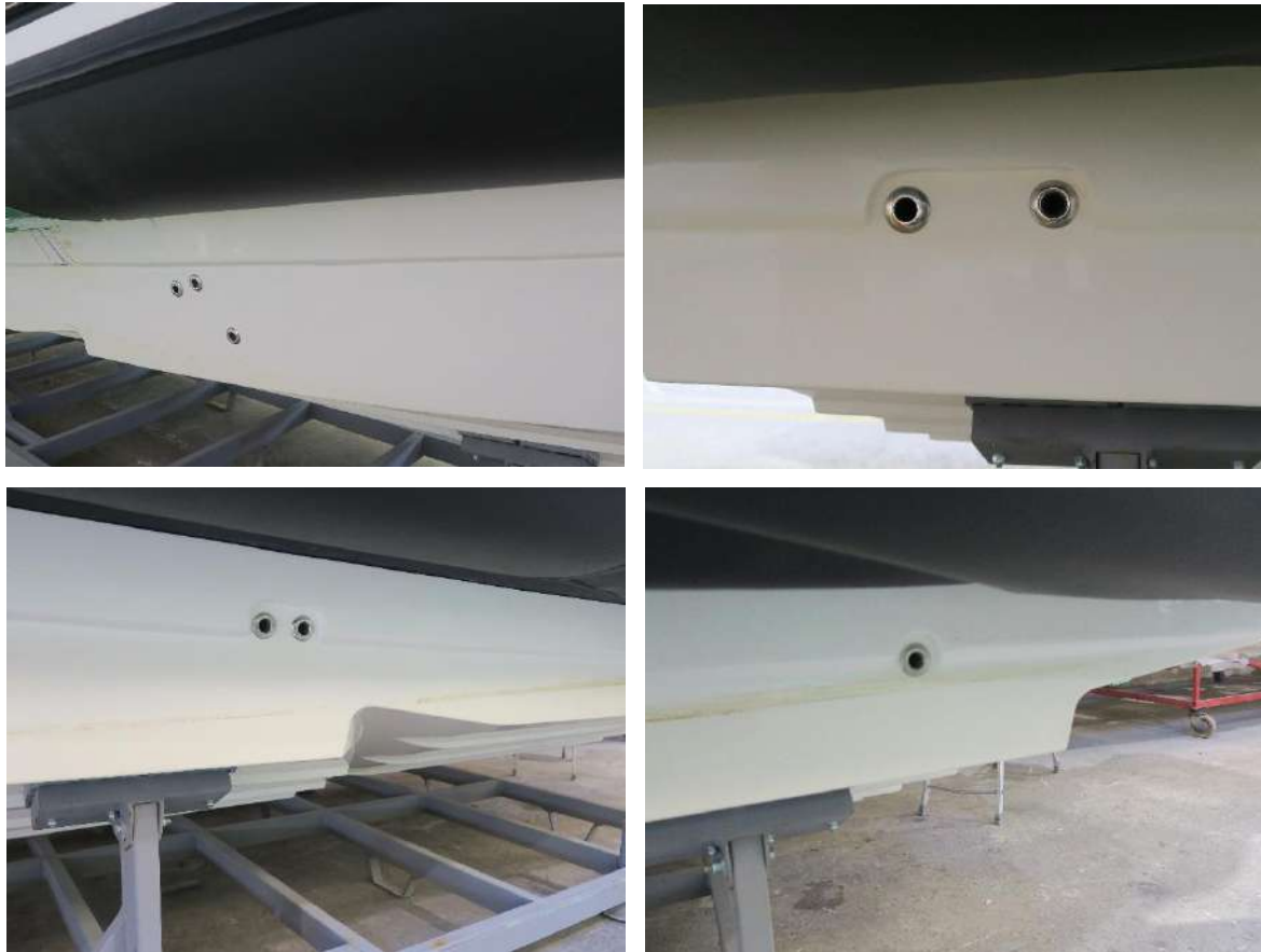
Dettagli dei passa-scafo
