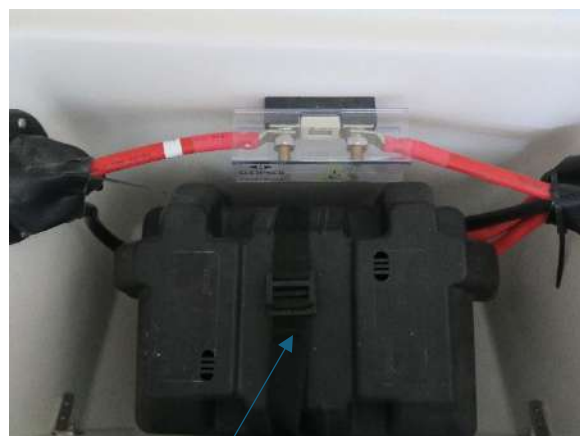
Detalle de las baterías (auxiliares y motores / propulsor de proa)
