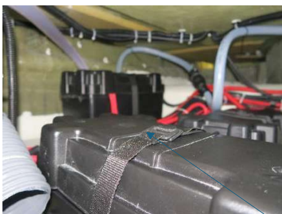
Détails des batteries (services et moteurs / propulseur d'étrave)
