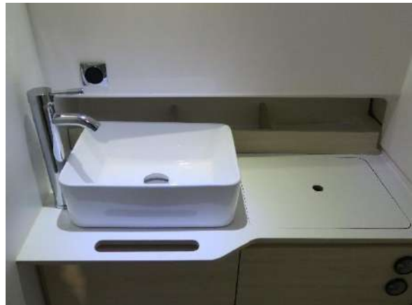
▪ Un toilette électrique relié au réservoir d'eau douce. ▪ Un meuble de rangement équipé d'une vasque (eau froide). ▪ Un accès technique au réservoir d'eaux noires ainsi que les jauges de remplissage du réservoir d'eau douce et du réservoir d'eaux noires. ▪ Un accès technique vers l'arrière du poste de barre.
