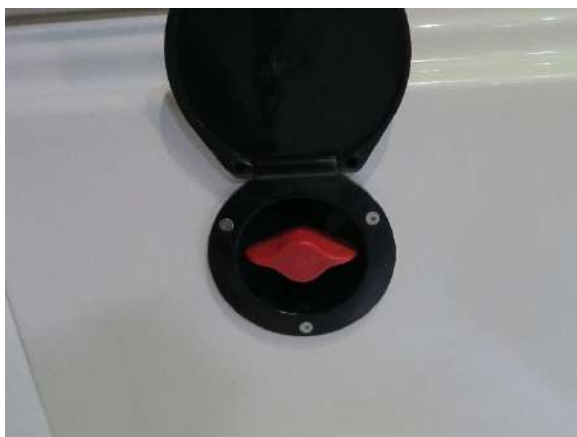
Interruptor de circuito del molinete y propulsor de proa
