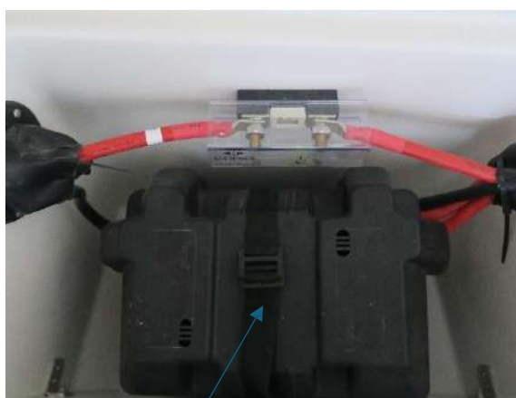
Détails des batteries (services et moteurs / propulseur d'étrave)
