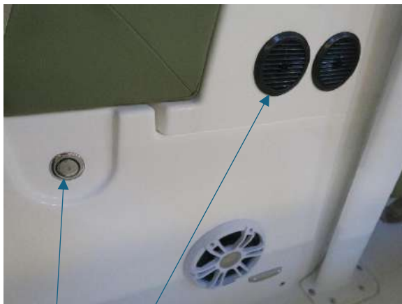
Sfiato del vano serbatoio
