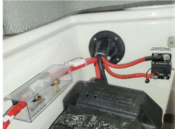
Interruttore e fusibile del verricello
