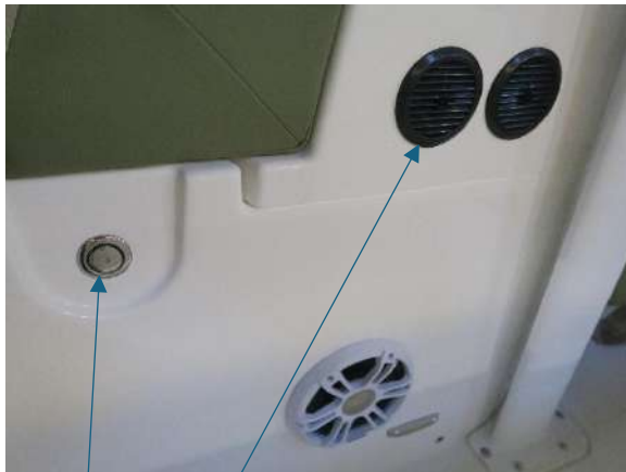
Entlüftung - Entlüftungen des Tankraums
